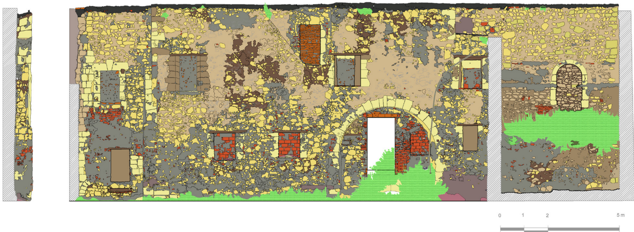
Fig. 3. Analisi materica del prospetto nord dell’ex monastero di S. Chiara in Cagliari, attualmente allo stato di rudere (elaborazione grafica M. Ennas, I. Ghirlanda, E. Pilia, I. Sinitina).
