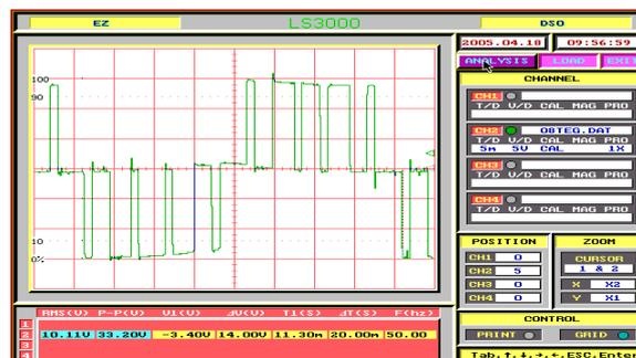
Gambar 9. Bentuk tegangan inverter MOSFET dengan indeks modulasi 0,81
