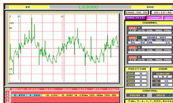
Gambar 10. Bentuk arus motor dengan indeks modulasi 0,81
