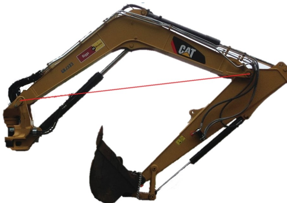
obr. 20 – Základní rozměr (znázorněný červenou čarou) – vzdálenost uložení výložníku
