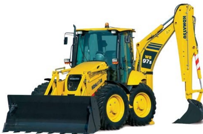
obr. 14 - Zemní stroj typu rypadlo-nakladač [22]
