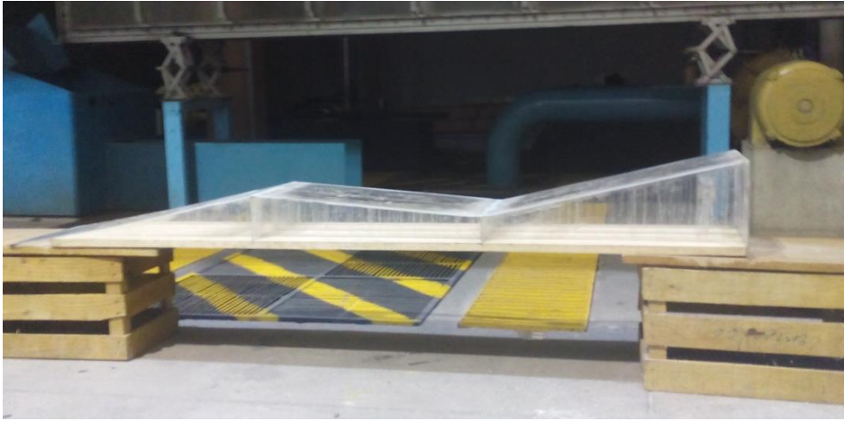
Figura 29. Modelo hidráulico construido con acrílico
