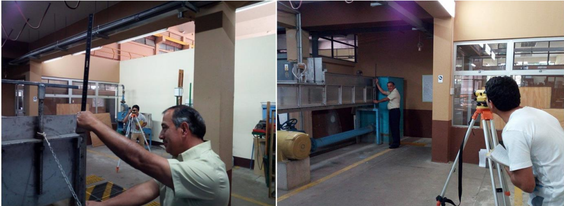
Figura 31. Nivelación del canal con nivel topográfico
