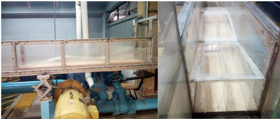
Figura 33. Colocación de modelo en el canal
