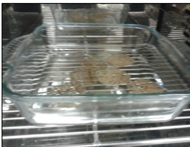
Figura 89- Corpos de prova na estufa em contato direto com água destilada.
