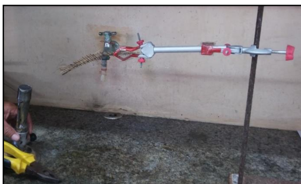
Figura 70- Análise de Flamabilidade com retardante de chamas.
