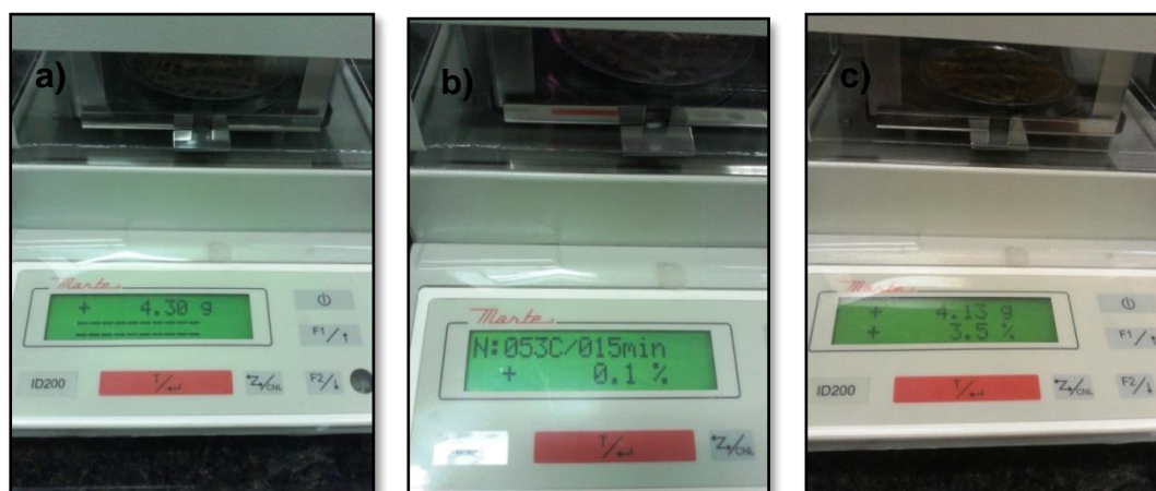
Figura 79- a) mostra a pesagem inicial do geotêxtil, b) equipamento realizado o aquecimento do tecido e realizado a análise da absorção de umidade, c) resultado da análise
