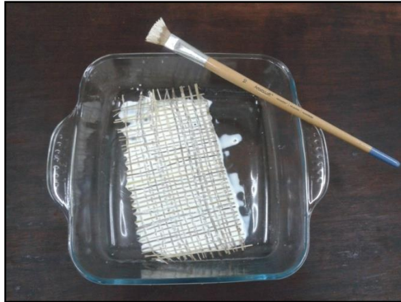
Figura 50- Corpos de prova sendo preparados para o teste de Degradação Ambiental.
