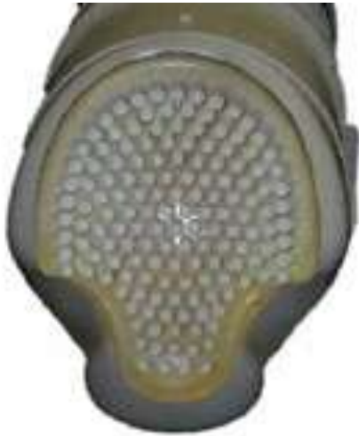
Abb. 3: Aufsicht auf die Sensorenschale des fMEG-Systems (Quelle: Department of Obstetrics and Gynecology, University of Arkansas for Medical Sciences, USA).
