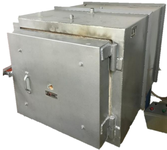
Figura 4. Horno de mufla, modelo E-S, marca Terrígeno.
