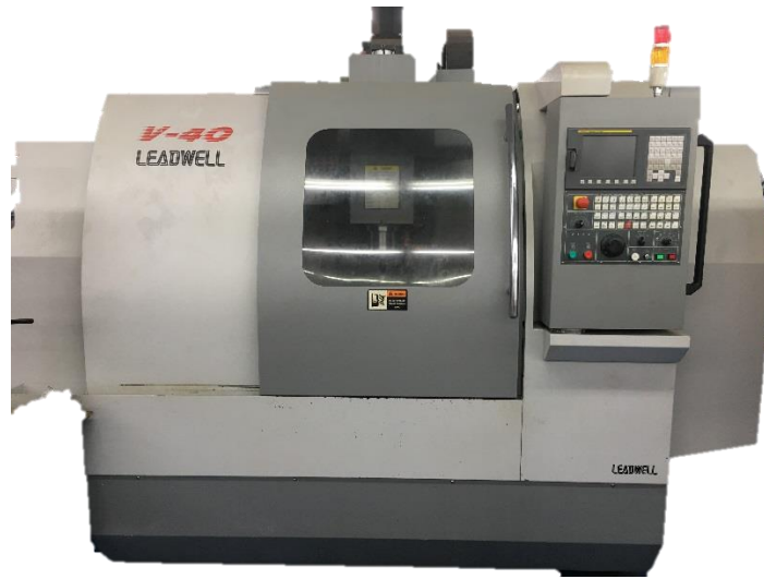
Figura 3. Centro de mecanizado vertical CNC, modelo V-40, marca Leadwell.
