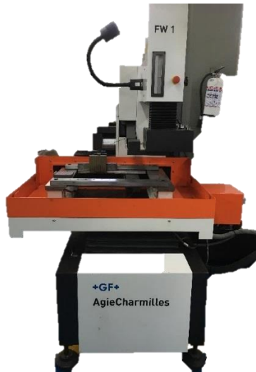
Figura 7. Máquina electroerosionadora de corte por hilo, modelo FW 1U, marca GF.
