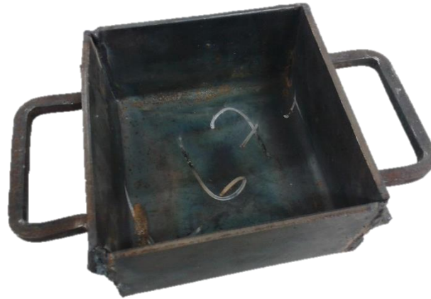
Figura 5. Caja de acero A36.
