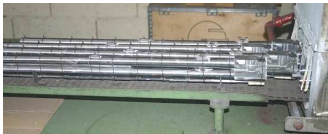
obr. 4.3 Hlavňové zväzky pred vložením do spájkovacej komory.
