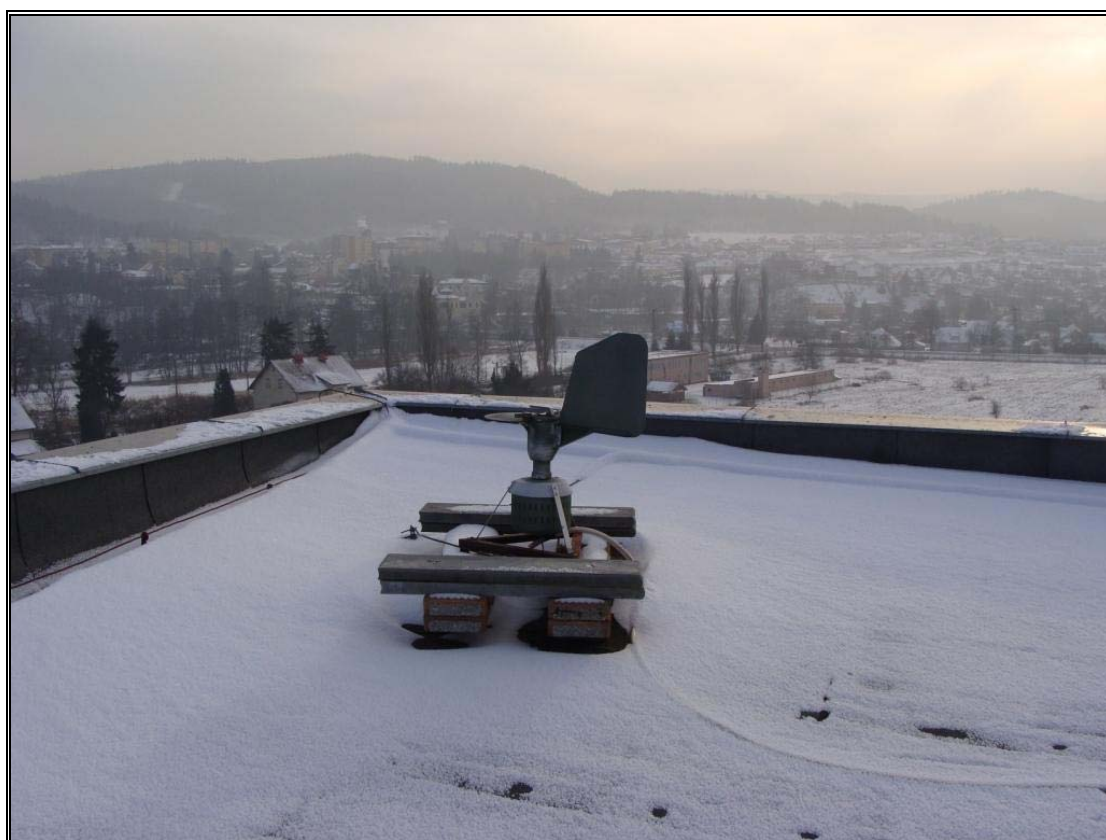
Obrázek 12- Lapač Burkard na budově ZÚ KV (Zdroj: Autor)
