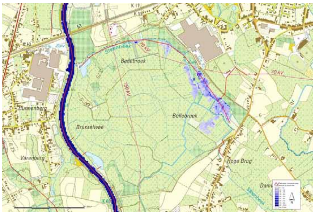
Figuur B2.8. Overstromingskaart van het Denderbellebroek bij het afslagpeil van het pompemaal (3,05 m T.A.W.)
