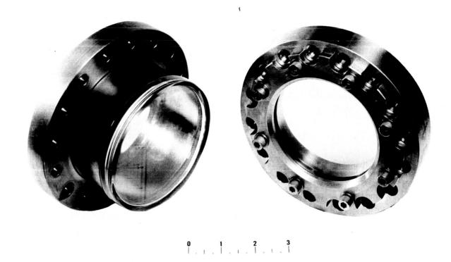
FIGURE 11 SIGHT PORTS FOR VACUUM CHAMBER. NEW TYPE IS AT RIGHT.
