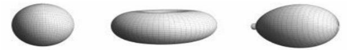
Fig. 2.5 Diagramas de radiación isótropo, omnidireccional y directivo [1]
