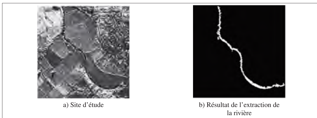
Figure 2.10 Résultat de l'application de la méthode de Sun & Mao (2011) sur une image RSO.
