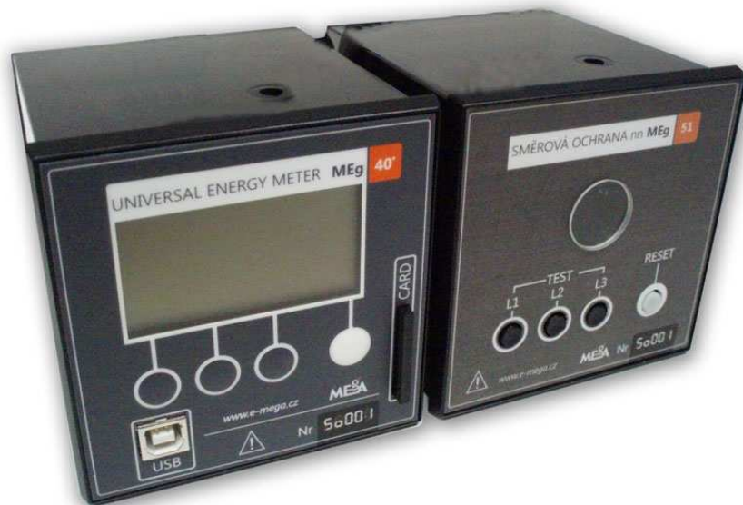
Obrázek 12: Souprava směrové ochrany: Univerzální monitor MEg40+ a jednotka MEg51.
