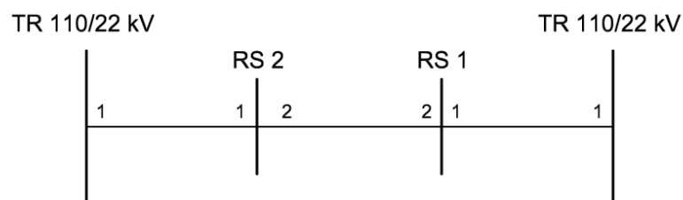
Obrázek 8: Způsob realizace jednoduššího systému „Linie“. [12]
