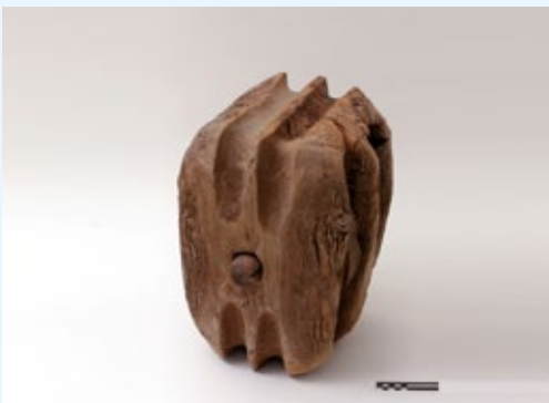
Blok of scheepskatrol afkomstig van een oud zeilschip. Opgevist uit de Noordzee
