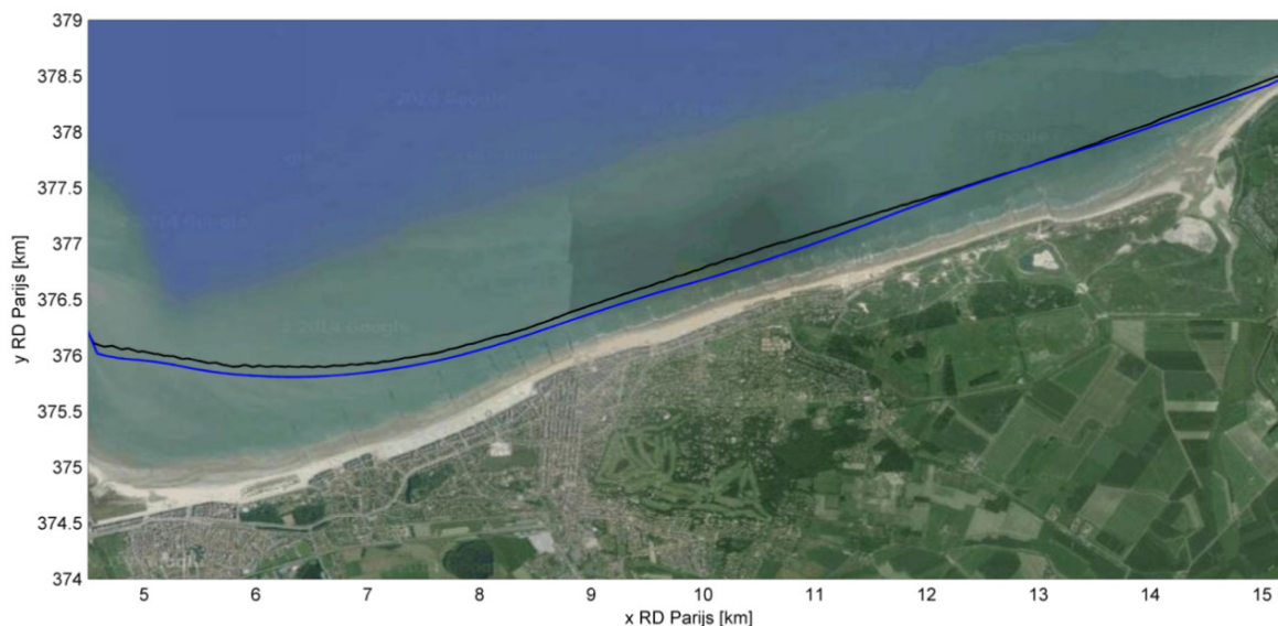
Figuur 69: Evolutie van de waterlijn (0mNAP) na drie jaar, zwarte lijn initiële waterlijn van de ontwerpsuppletie, blauw: positie waterlijn na 3 jaar.
