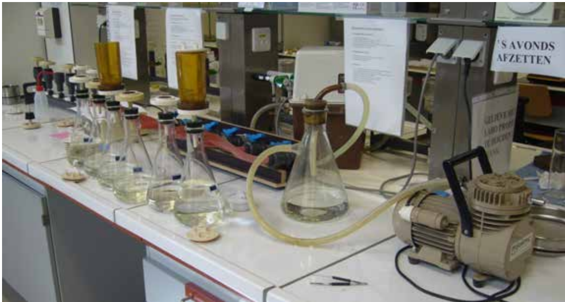
Figuur 7 – Sedimentologische laboratorium waterstalen filtratie
