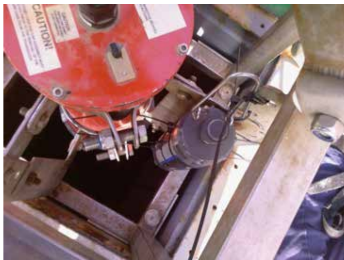
Figuur 6 – YSI multiparametersensor gemonteerd naast een ingebouwde ADCP©
