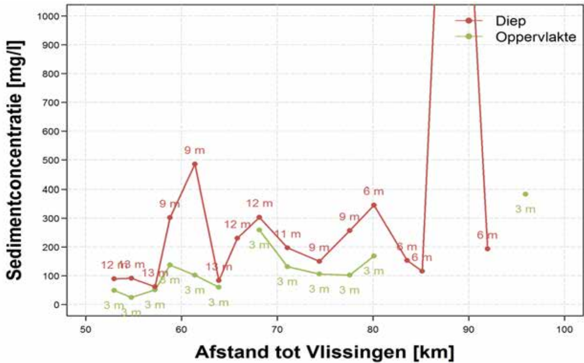
Figuur 99 – Overzicht sedimentconcentratie (september 2009) Beneden-Zeeschelde halftij-eb voor stalen aan de bodem, in het midden en aan het oppervlak
