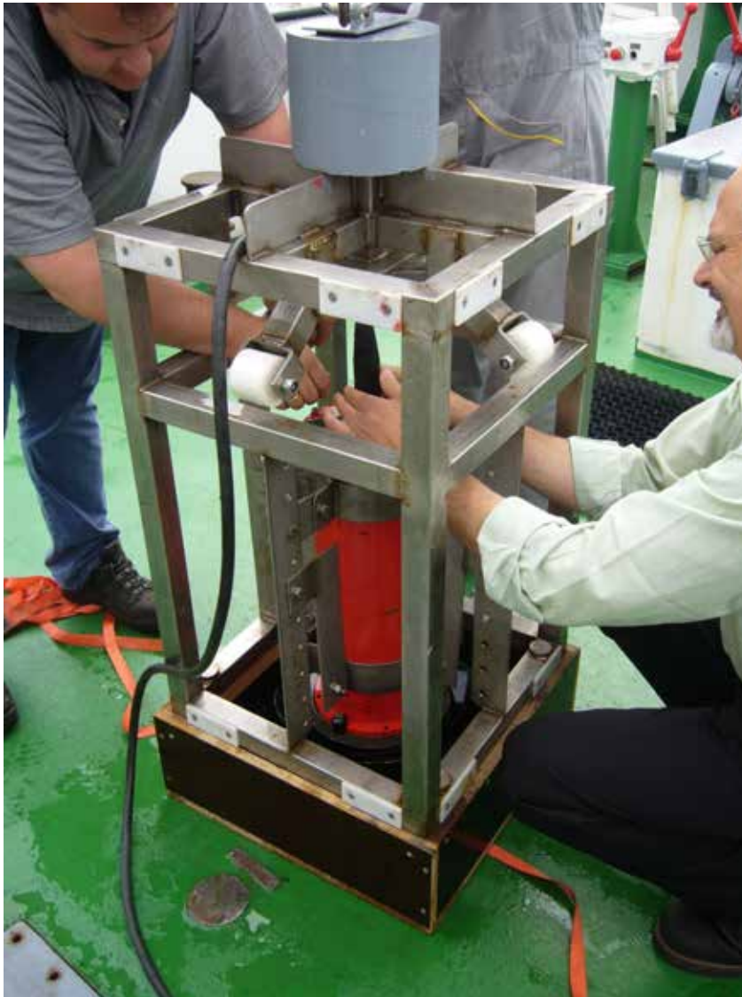
Figuur 3 – Montage Sentinel ADP in de schacht van de Pierre Petit op 26/05/2008
