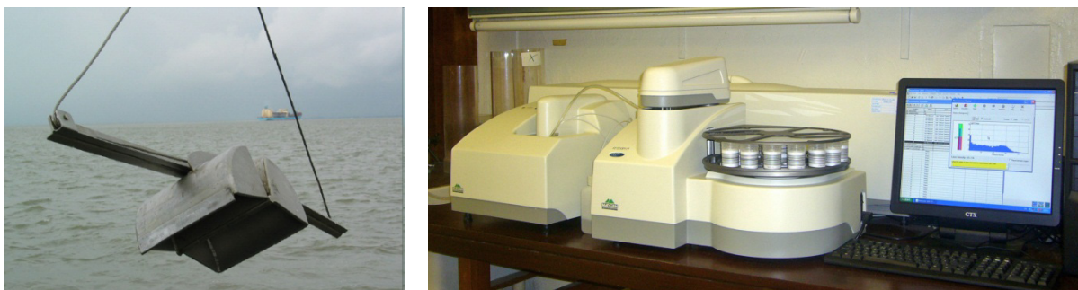
Figuur 3 – Van Veen-grijper (links) en Mastersizer 2000 (rechts)
