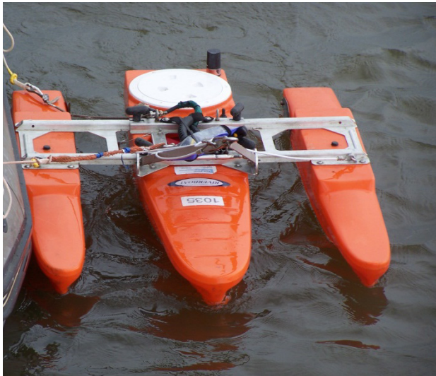
Figuur 1 – Foto RDI Workhorse Rio Grande (links) en werkingsprincipe ADCP (rechts)
