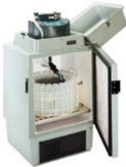
Figuur 126 - Automatisch staalnametoestel ISCO (type 6712FR) met koeling Teledyne (Teledyne Technologies Inc.; 2012).
