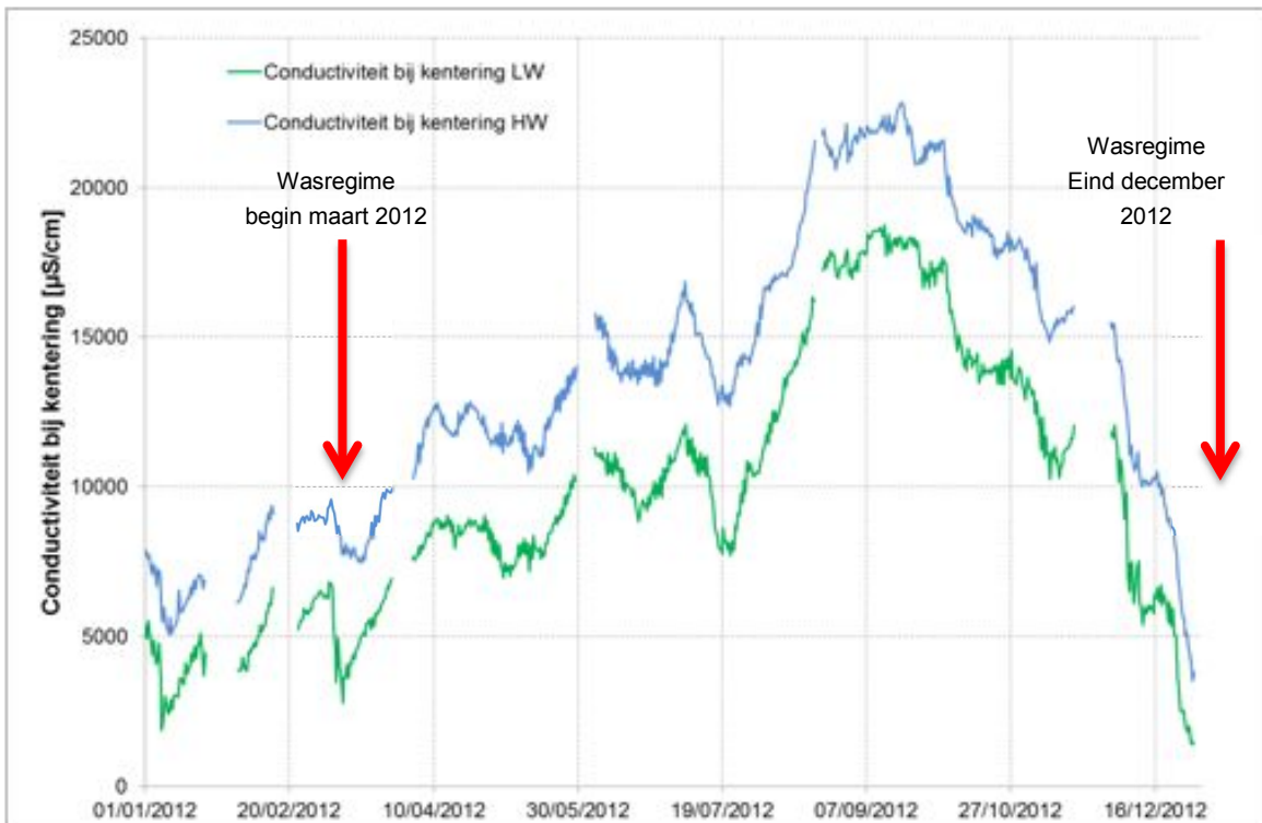
Figuur 83 - Conductiviteit bij KHW en KLW te Boei84 (Beneden- Zeeschelde), bovenste meettoestel
