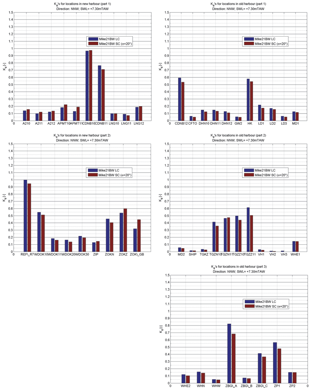
Figuur 3-26: K_d -waarden voor de locaties in de nieuwe voorhaven (links) en oude haven (rechts). Vergelijking tussen lang- en kortkruinige golven.
