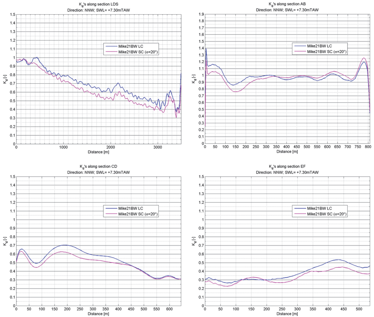
Figuur 3-27: Evolutie van K_d -waarde volgens langdoorsnede LDS H en dwarsdoorsneden AB (ingang van de haven, x_{LDS} = 0 m), CD (ingang oude haven, x_{LDS} = 2000 m) en EF (ingang dok Vandammesluis, x_{LDS} = 2800 m). Vergelijking tussen lang- en kortkruisige golven.
