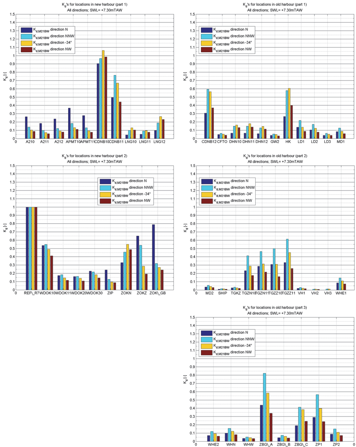
Figuur 3-24: K_d -waarden voor de locaties in de nieuwe voorhaven (links) en oude haven (rechts). Vergelijking tussen de verschillende golfrichtingen.
