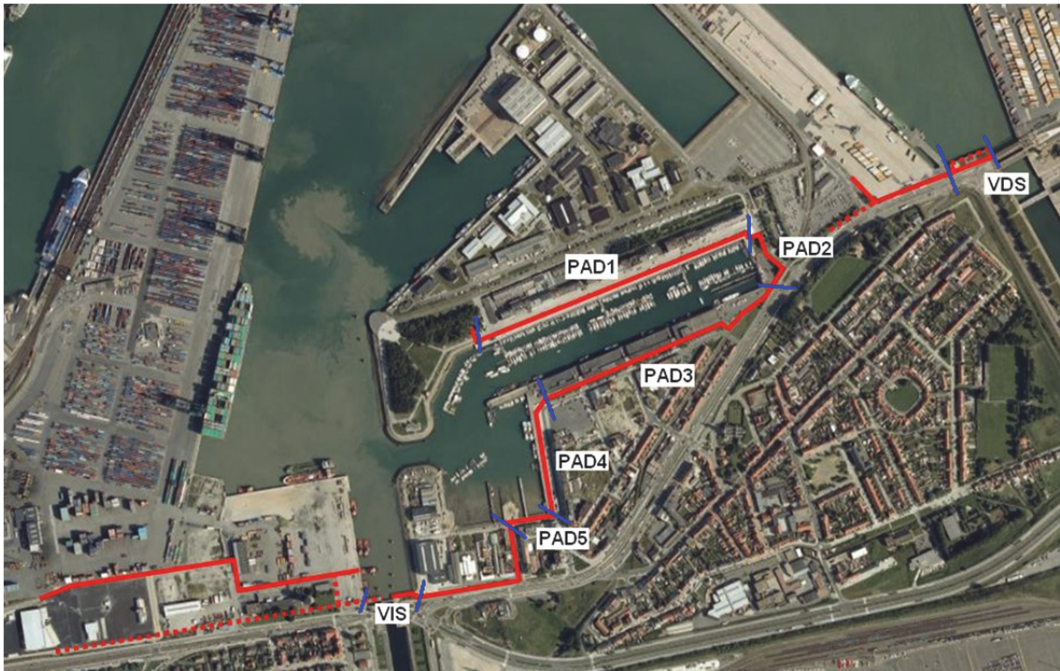
Figuur 4-2: Aanduiding van zones waarvoor de golfcondities ten gevolge van lokaal wind gegenereerde golven bepaald worden uit de SWAN simulatie resultaten.
