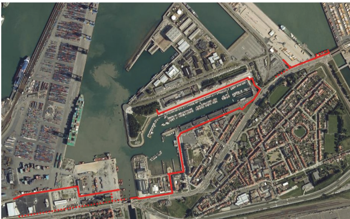
Figuur 1-1: Tracé van de overstromingsmaatregelen in de haven van Zeebrugge. Van west naar oost: de Visartsuis, rondom het Prins Albert I dok en ten westen van de Vandammesluis (Afdeling Kust, 2011).
