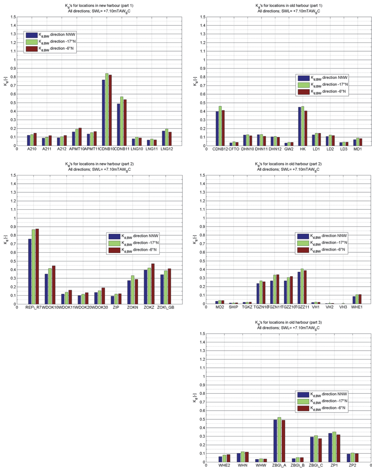
Figuur 3-41: K_d -waarden voor de locaties in de nieuwe voorhaven (links) en oude haven (rechts). Mike 21 BW, incl. vaargeul, kortkruinige golven ( \sigma = 20^\circ ). Vergelijking tussen de golfrichtingen offshore van de vaargeul: NNW, -17°N en -6°N.
