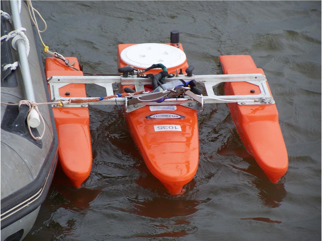
Figuur 2-1: Meetopstelling meting groep 2. De ADCP zit in de middelste drijver van de trimaran. De handheld GPS ligt bovenop de middelste drijver.
