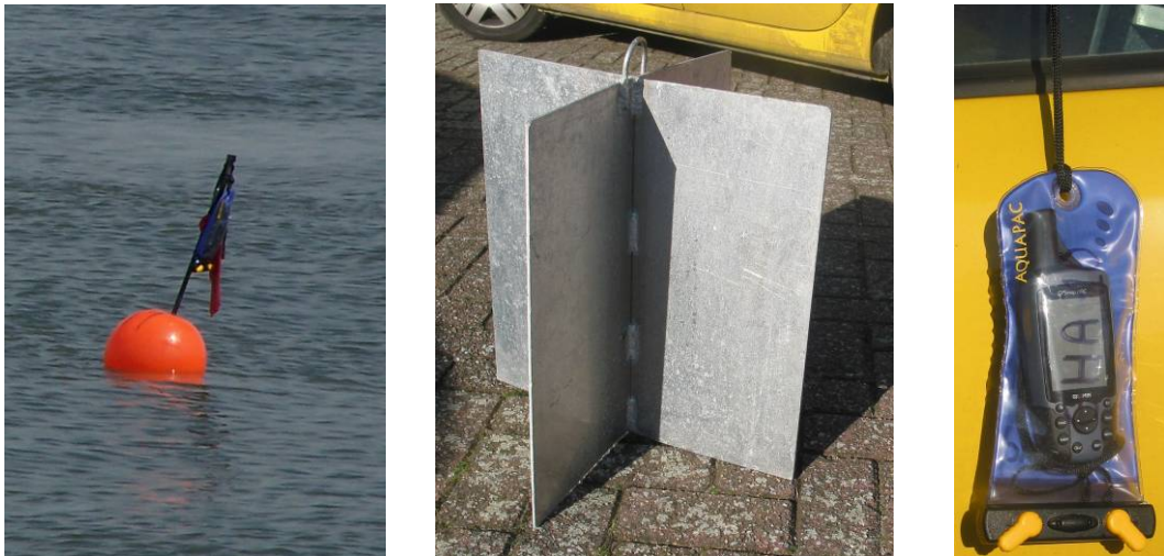
Figuur 1 – Onderdelen GPS vlotter: boei (links), kruisvormig paneel (midden), GPS-toestel (rechts)
