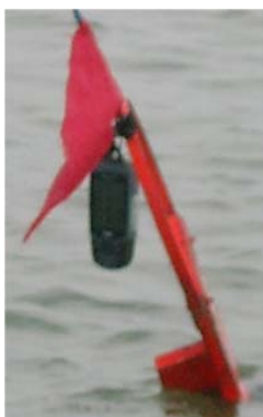
Figuur 2-4 Handheld Garmin GPSMAP 60 C bevestigd op diepdrijver
