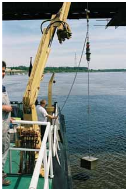
Aanderaa met neerwaartse ketting naar betonsteen (die op de rivierbodem wordt gezet)
