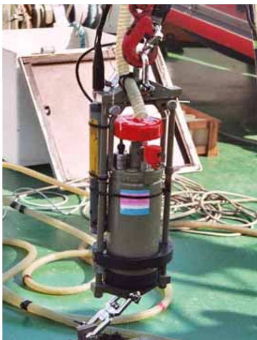
Een Aanderaa-RCM-9-meettoestel, omvattende cilindrisch lijf (waarin elektronica, voeding en datablok) en de vijf meetsondes bovenaan (de rode "paddestoel" bovenaan meet via Doppler-effect de vectoriele watersnelheid)
