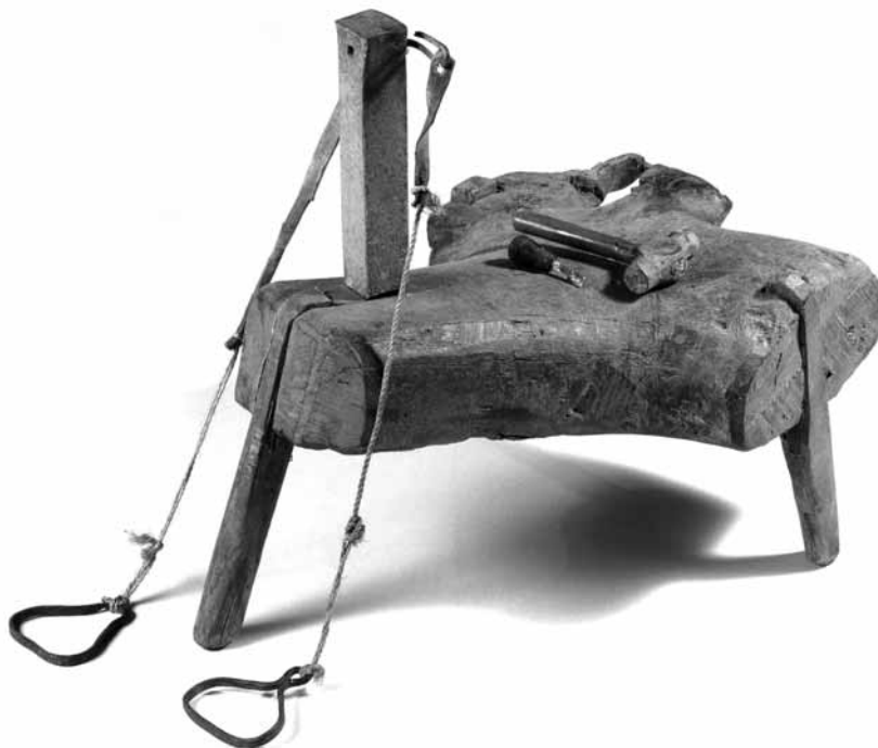
Fig. 4 Banco de picar foicinhas (MNE AY. 239) com martelo (MNE AY.240) e punção (MNE AY.241) de Cachopo, Tavira. Fotografia cedida pela Divisão de Documentação Fotográfica do IPM. Autor: José Pessoa.
