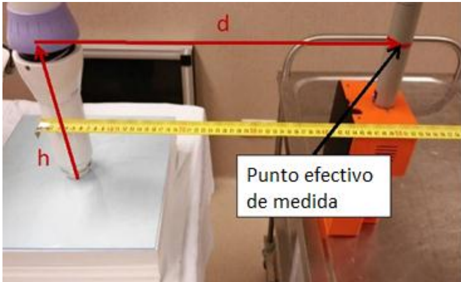
Figura 2-1. Montaje experimental utilizado para medir la tasa de dosis equivalente ambiental a diferentes alturas, h , y distancias, d , desde la superficie de salida del aplicador de la equipo Esteya.
