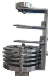
Abb. 40: Maskenwechselsystem zur Herstellung strukturierter Proben (links) und die in das Loadlock integrierte dreifache Probenaufnahme (rechts) mit Garage für fünf Bedampfungsmasken. Die Maske für den oberen Elektrodenkontakt ist in der Schemazeichnung nicht dargestellt.
