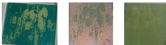
Abb. 67: Vorder- und Rückseite einer mit Lithium hochinterkalierten TCNQ-Schicht. Links: Vorderseite ( \text{TCNQ}^{2-} ), Mitte: Vorderseite in reflektierendem Licht, Rechts: Rückseite ( \text{TCNQ}^{0/1-} ).
