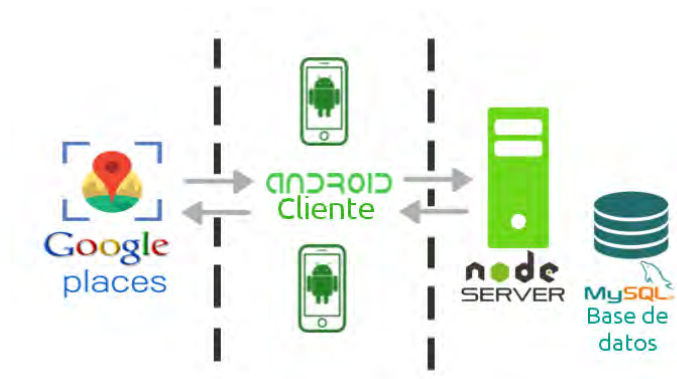
Fig. 1. Arquitectura Cliente-Servidor implementada de la que forma parte la aplicación Android presentada. El servidor es desarrollado con Node.js y usa MySQL como motor de gestión de base de datos. Aparece la API de Google Places como servicio usado por el cliente para conseguir un autocompletado de direcciones a la hora del registro.
