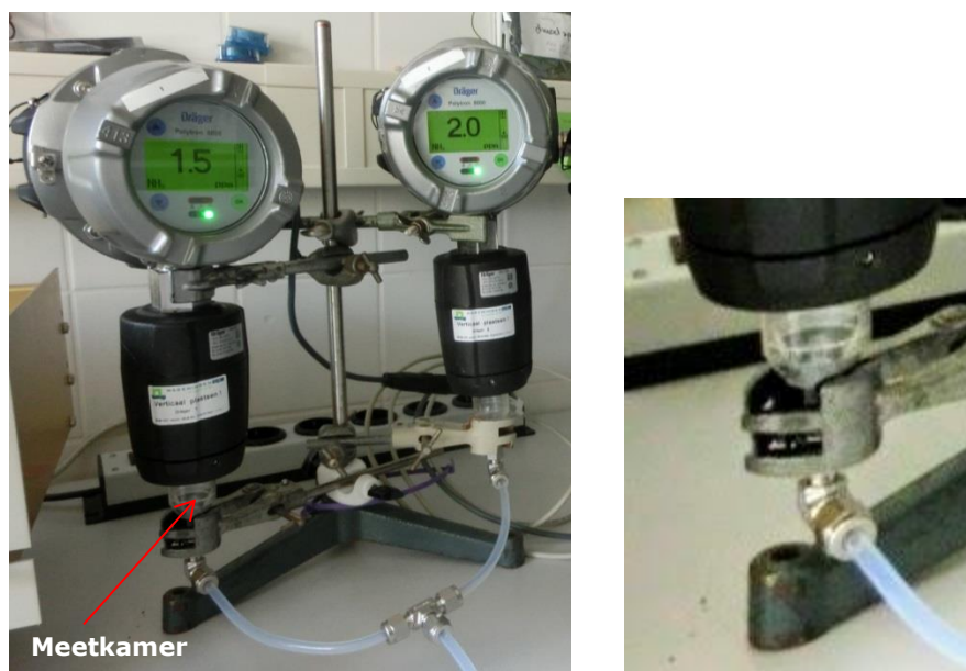
Figuur 1 Twee Dräger NH 3 -sensor FL-6813260 met meetkamers zoals gebruikt tijdens kalibratie in het lab.
