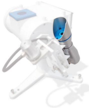
Figure 6 - Pyrhéliomètre monté sur un tracker EKO
