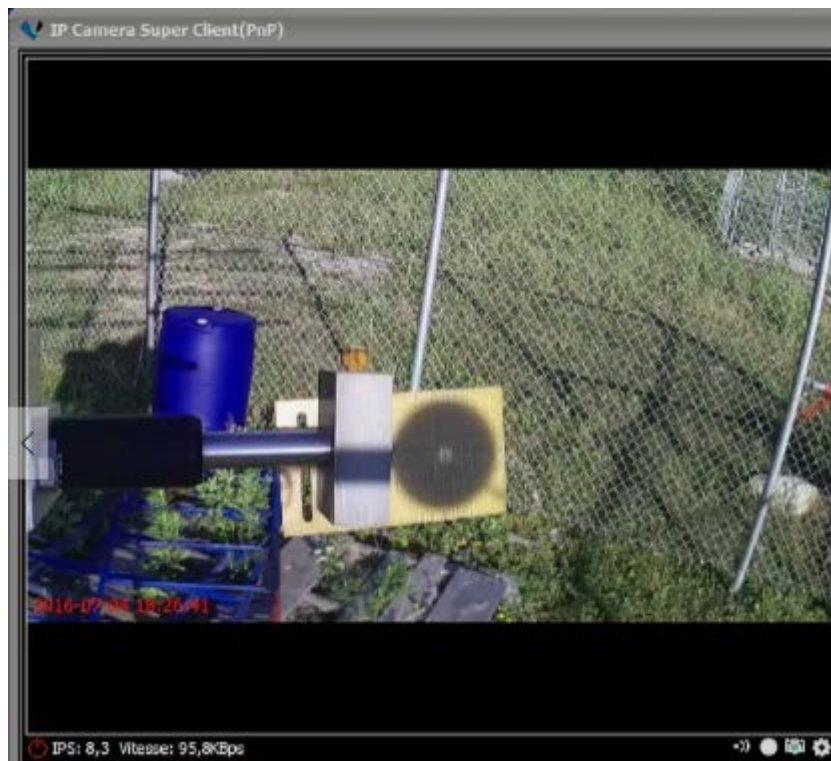
Figure 19 - Capture d'écran d'une vue à distance par la caméra d'observation, de la projection de l'ombre du diaphragme et de l'irradiation collimée.
