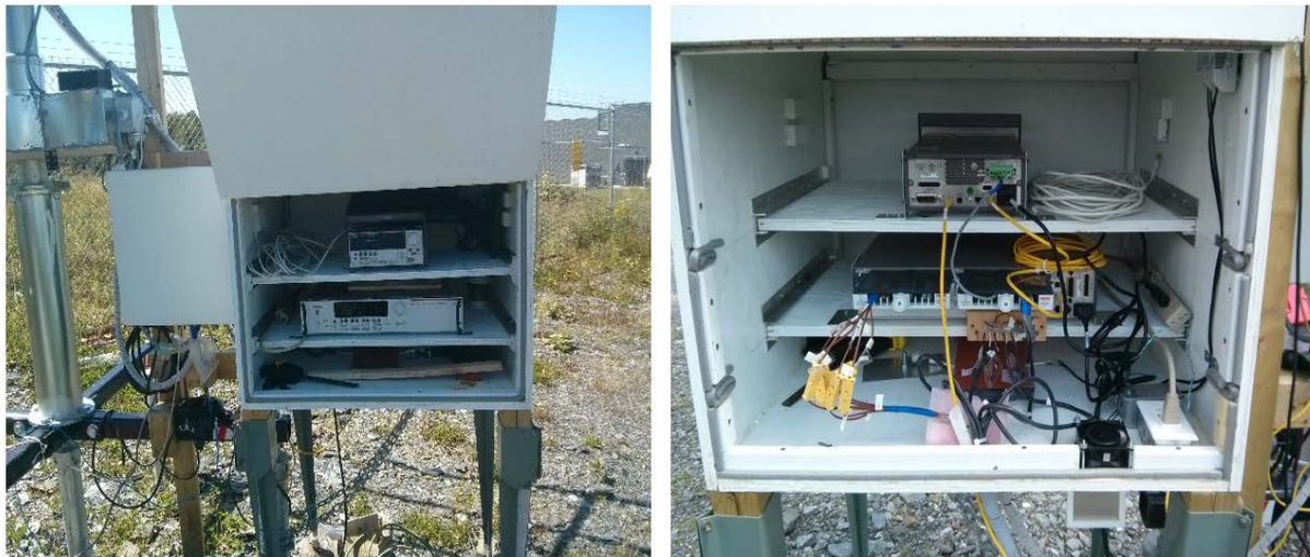
Figure 20 - Le SMU 2601A (haut) et le DMM 3706B (centre) dans leur boîtier extérieur chauffé et ventilé. Photo de gauche, vue avant. Photo de droite, vue arrière. Le DMM lit par les thermocouples (connecteurs jaunes) la température des cellules CPV. Le DMM fait le pont entre les DUT et le SMU.
