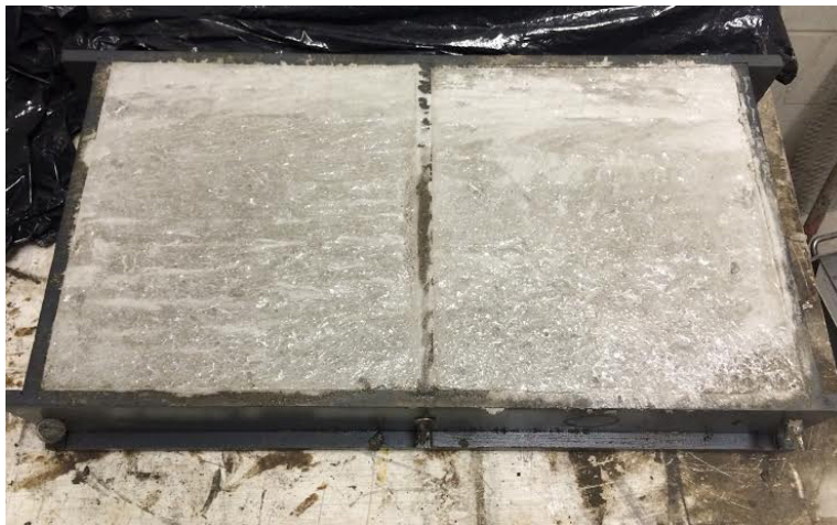
Figure 4-14 Plaque d'écaillage une fois l'agent de mûrissement appliqué
