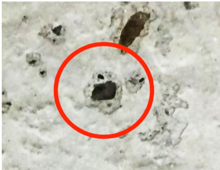
Figure 4-6 Cône de pâte détachée et fracture visible à la surface du granulat
