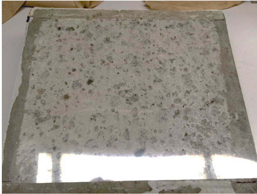
Figure 4-8 Acétate appliquée sur la surface de la plaque à analyser
