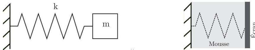
Figure 4.4 Système de résonance masse-ressort d'une configuration bicouche.
