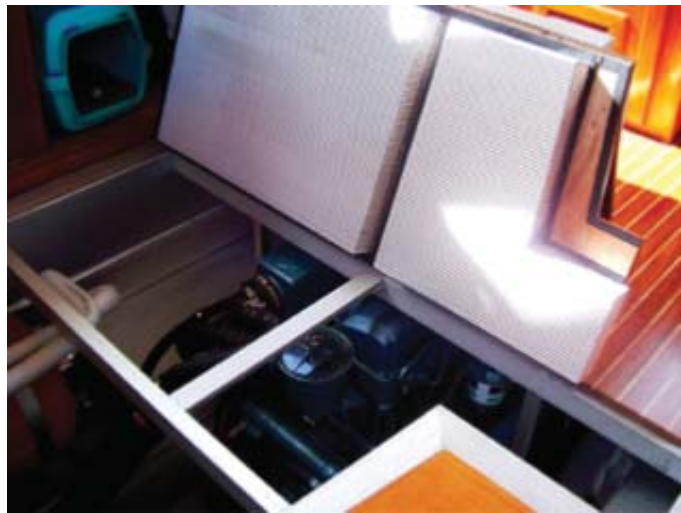
Figure 2.1 Absorbeurs microperforés utilisés dans le compartiment moteur d'un bateau [Herrin et Liu, 2011]
