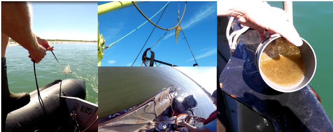
Figuur 7. Het testen van het zooplanktonnet. Links - gesleept vanuit de rubberboot. Midden-boven – opgehangen boven het DFS-tuig. Midden-onder – opgehangen in de 2m boomkor vanuit de rubberboot. Rechts – het planktonnet en de opvangfilter slaan dicht als gevolg van de slibdeeltjes in het water.
