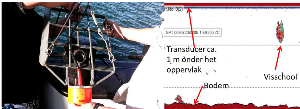
Figuur 12. De 200 kHz transducer bevestigd aan een depressor, die ervoor zorgt dat het stabiel in positie blijft. De transducer is het enige onderdeel van het echolood dat zich in het water bevindt. De transeiver (dat is het apparaat dat de geluidspulsen produceert en ontvangt), het software- en het opslag-gedeelte, bevinden zich aan boord.
