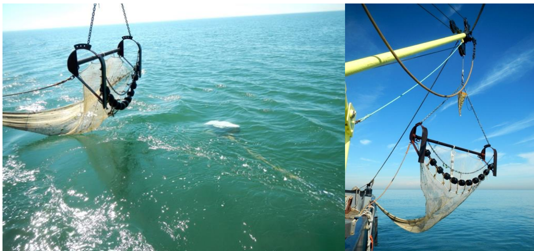
Figuur 9. Links - de DFS boomkor tijdens het halen. In het water is de uitscherende towed body zichtbaar. Rechts - het DFS vistuig tussen twee trekken. In de spruit (bevestiging net aan de giek) hangt het planktonnet. In het midden haaks op de boom, is de Hydrolab datalogger bevestigd.
