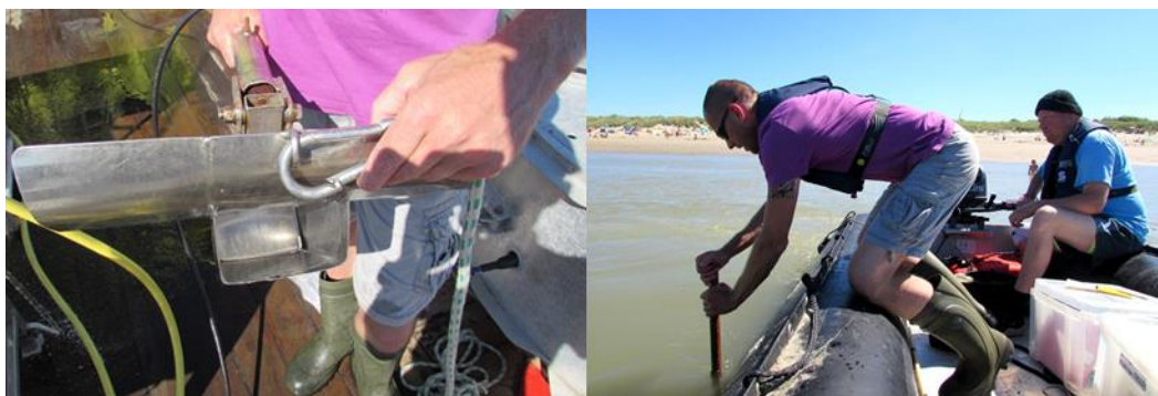
Figuur 3. Kokkelschepje. Links: scheppend gedeelte onderaan de stok. Rechts : in actie.
