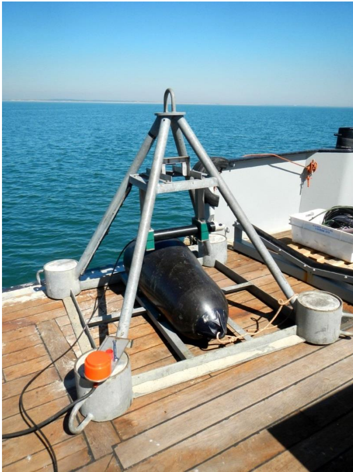
Figuur 14. Het statisch bodemstation. Links voor is de 333kHz transducer (oranje) bevestigd. In het midden is de ADCP-logger horizontaal gemonteerd in twee groen gekleurde houders. De zwarte stootboei werd gebruikt tijdens de test om de positie van het station te markeren.
