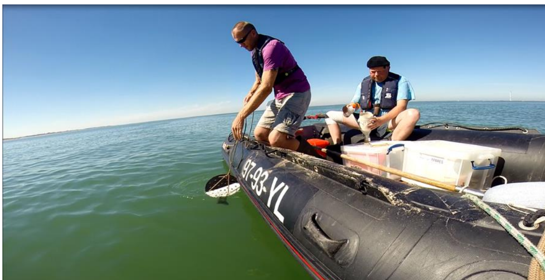
Figuur 16. Bepaling van het doorzicht met de Secchi-schijf vanaf de rubberboot.
