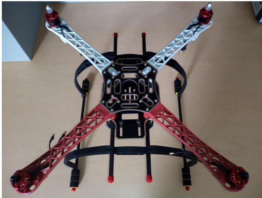
Figura 17 MONTAJE FINAL DE LOS MOTORES EN EL CHASIS
