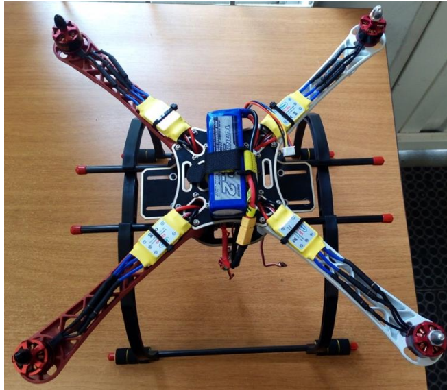
Figura 23 MONTAJE DE LA BATERIA
