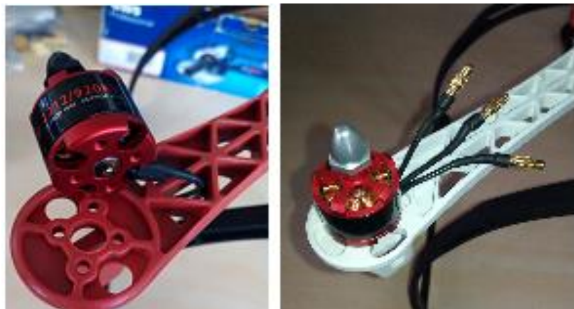
Figura 16 MONTAGE DE MOTORES
