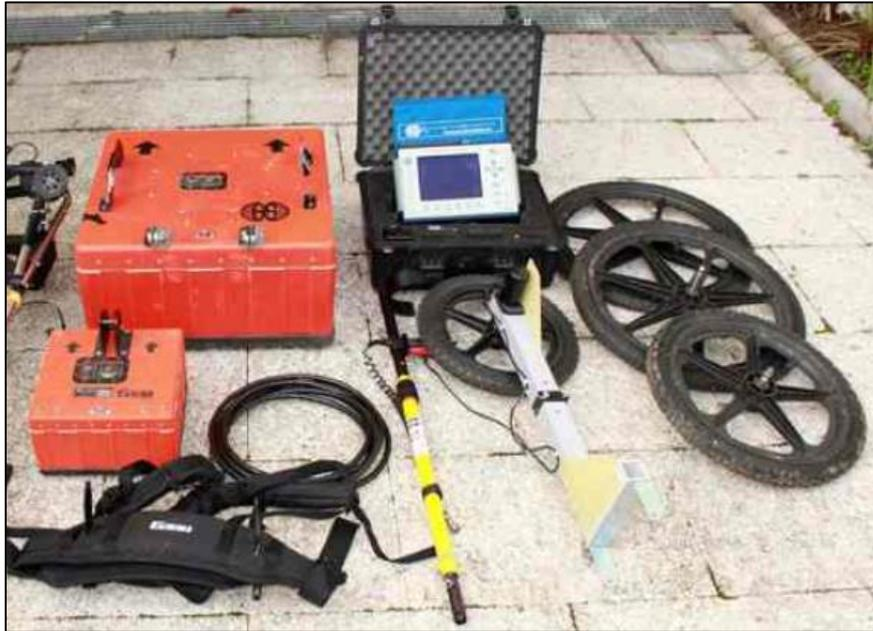
**Figura 15** – Equipamento de Georradar utilizado no decurso desta dissertação, produzido pela GSSI: antenas de 200 MHz e 400 MHz; SIR-3000; *survey wheel* com odómetro e cabos de ligação (Imagem cedida por Gonçalves, L.).
