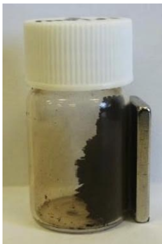
Figura 4.10 – Imagem das nanopartículas de \text{Fe}_3\text{O}_4@AO sintetizadas em que mostra também o seu comportamento magnético.
