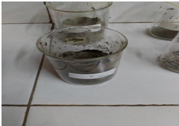
Sampel sedimen yang telah dikeringkan dengan menggunakan oven
