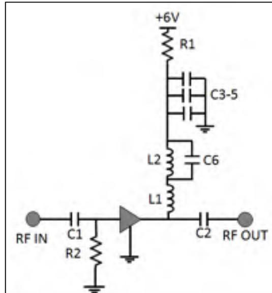
Figure 3.5 Modification permettant l'accentuation des effets de mémoire
