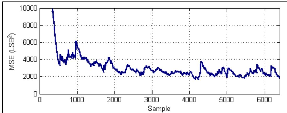
Figure 4.29 Convergence de l'algorithme LMS en classe AB
