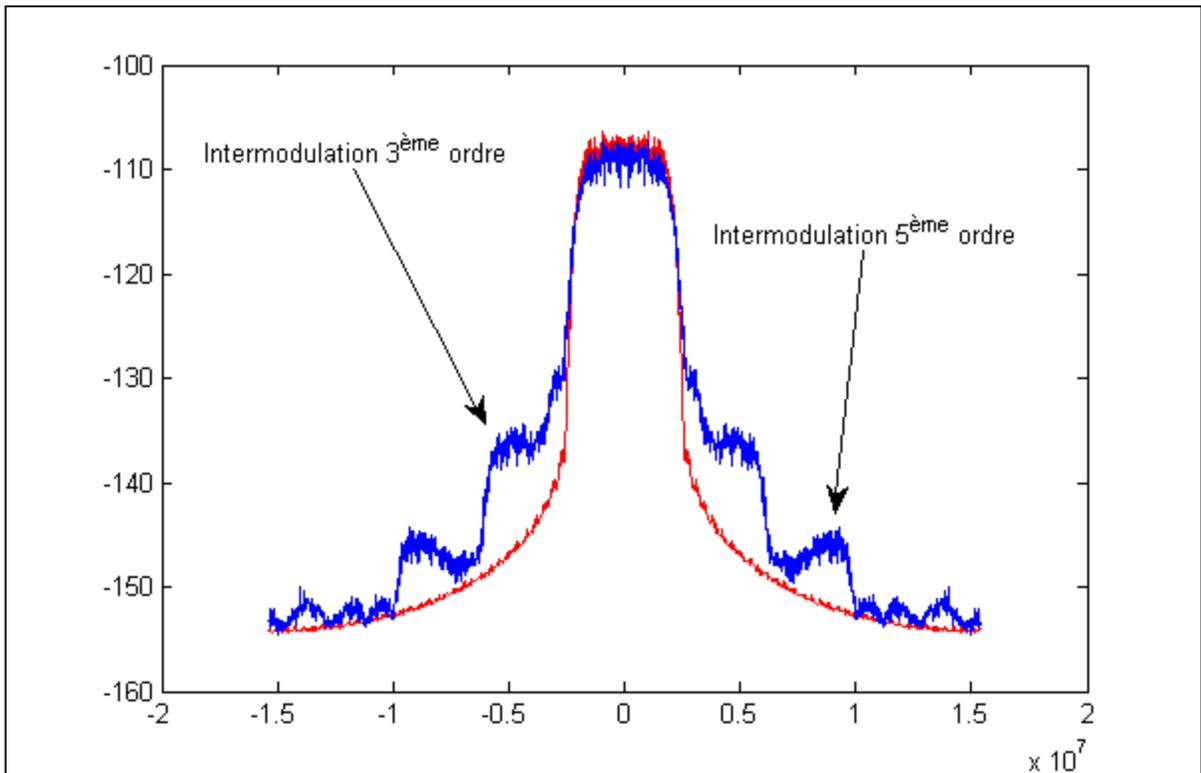
Figure 1.3 Intermodulation sur un signal numérique (3.84MHz de largeur de bande) comparé à un spectre sans distorsion
