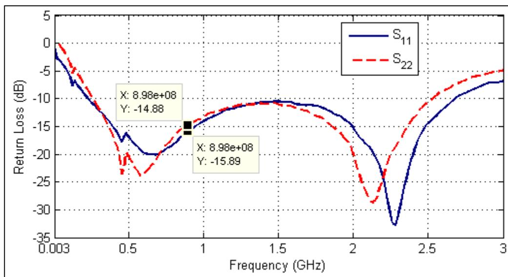
Figure 4.2  $S_{11}$  et  $S_{22}$  mesurés en dB
