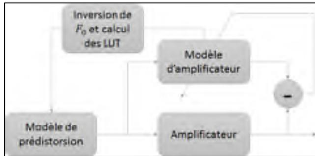
Figure 1.7 Système de prédistorsion avec inversion de modèle
