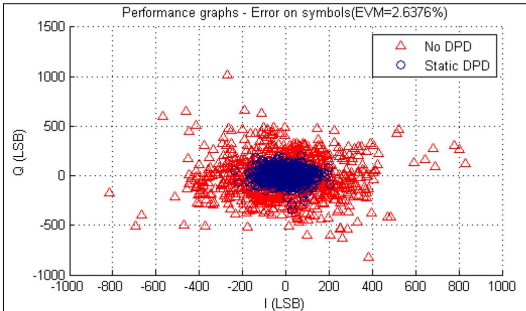
Figure 4.31 Vecteur d'erreur mesuré en classe AB
