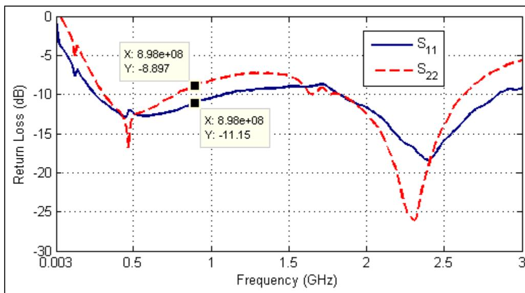
Figure 4.7  $S_{11}$  et  $S_{22}$  mesurés en dB
