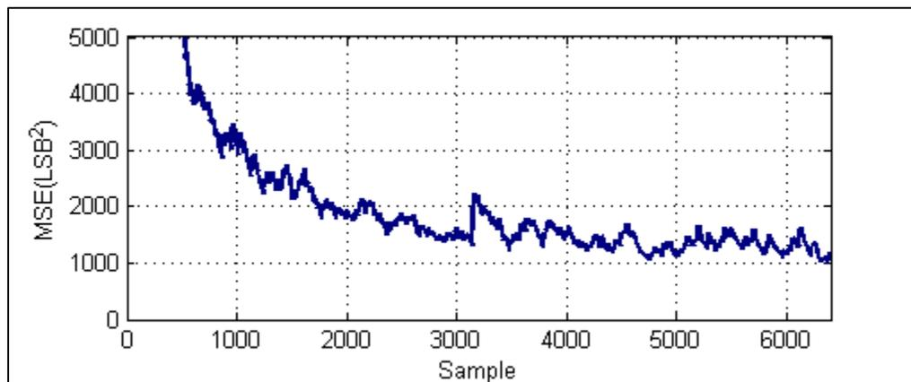
Figure 4.18 Convergence de l'algorithme LMS en classe A
