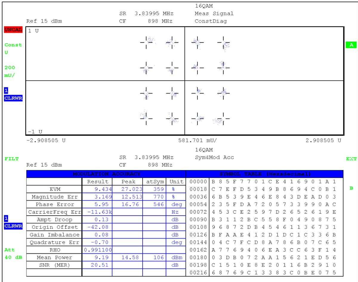
Figure-A I-8 Signal 16-QAM reçu sur le VSA
