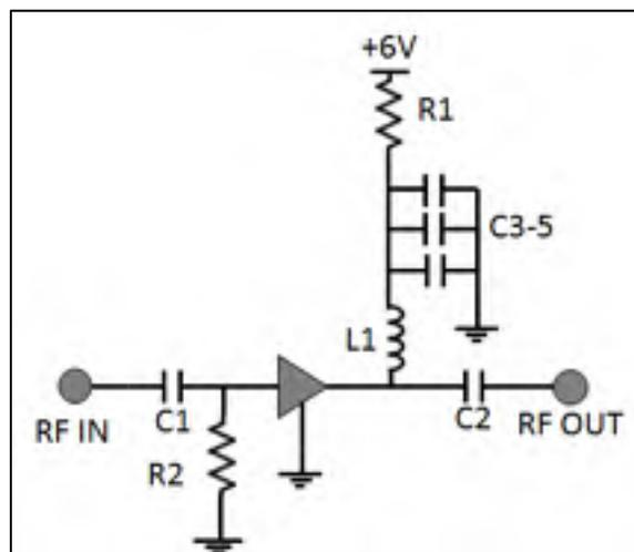
Figure 3.3 Amplificateur polarisé en classe AB profonde
