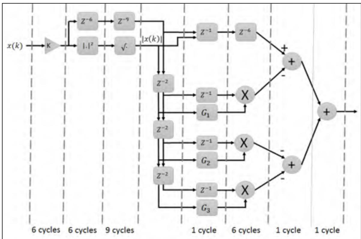
Figure 2.10 Pipelinage de l'étage FIR
