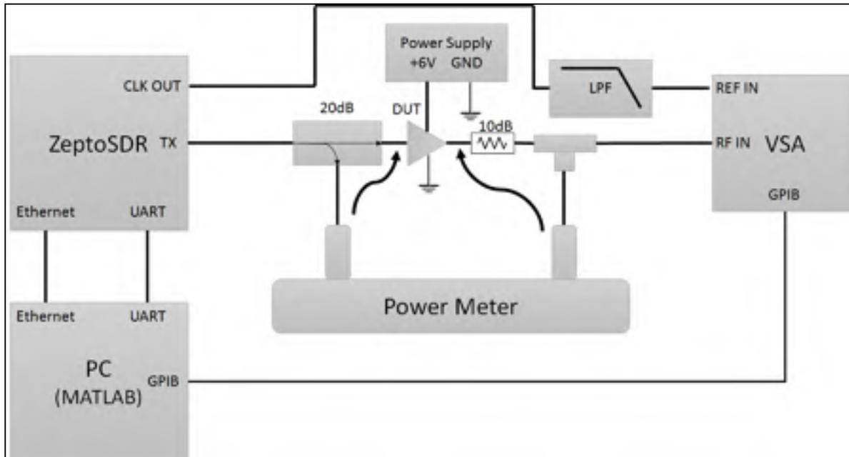
Figure 2.2 Schéma synoptique du banc de caractérisation
