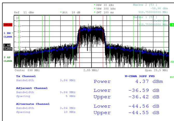
Figure 4.34 Puissances mesurées dans les canaux adjacents et alternes après prédistorsion en classe AB
