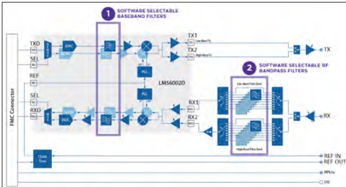
Figure 2.1 Diagramme synoptique de la carte Radio420s
