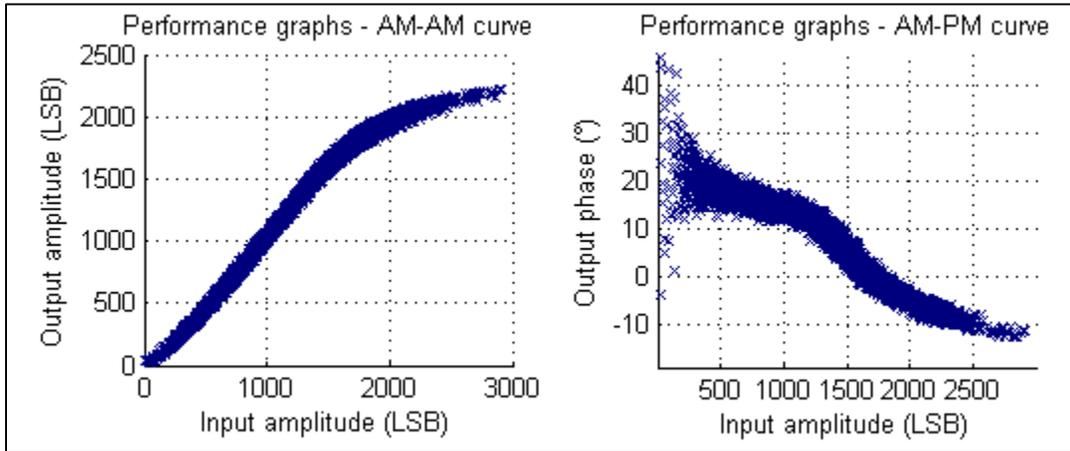
Figure 4.27 Courbes AM-AM et AM-PM de la caractérisation
