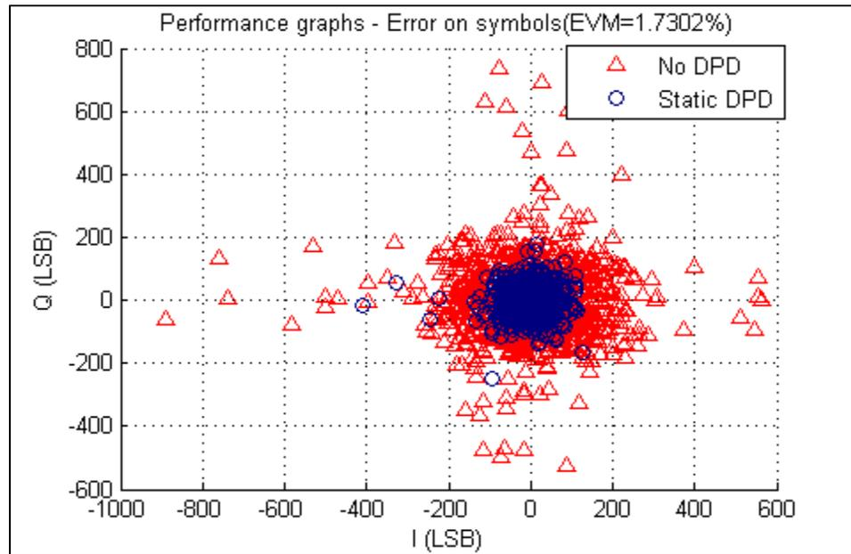
Figure 4.20 Vecteur d'erreur mesuré en classe A
