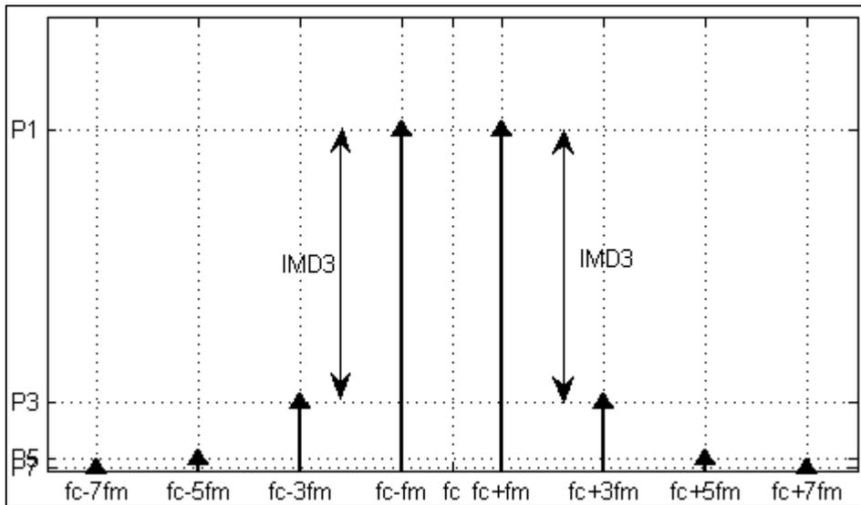
Figure 1.2 Les IMD3 à la fréquence porteuse  $\pm 3f_m$ ,
