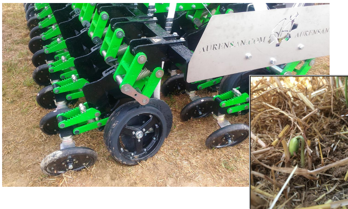
FIGURE I.2.2 – Semoir de semis direct par arrachement. Technologie développée par Alain Aurenсан dans le Sud Ouest de la France : la double inclinaison du disque semeur. CREDITS PHOTO : A. Aurenсан
