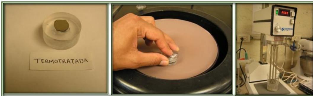
**Fig. 22.** Preparación de varillas antes del ensayo de microdureza por Vickers.
