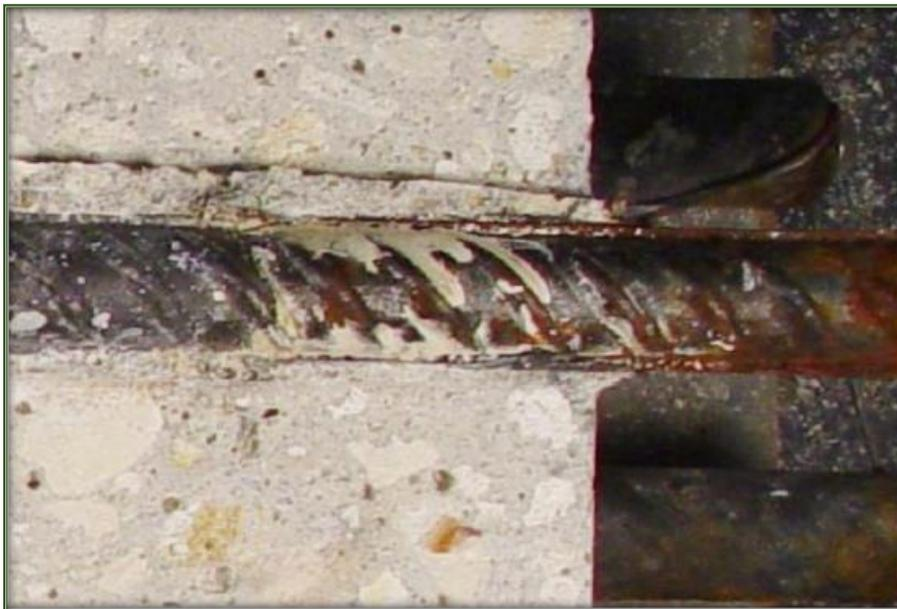
Fig. 69. Corrosión de la varilla de acero en la interface varilla-concreto-ambiente (Hartt, 2016).
