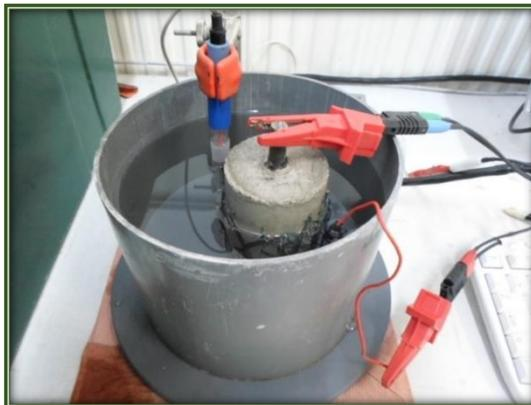
Figure 18 : Montage expérimental pour le tracé des courbes de polarisation et l'identification des paramètres de Tafel.
