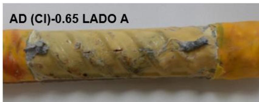
**Fig. 95.** Estado de la superficie localizada en el área de estudio de las varillas ADCl expuestas a ambiente controlado en laboratorio: relación a/c de 0.65.
