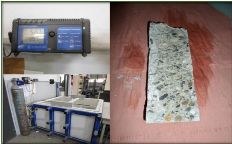
**Fig. 39. Sistema de carbonatación y espécimen carbonatado totalmente.**
