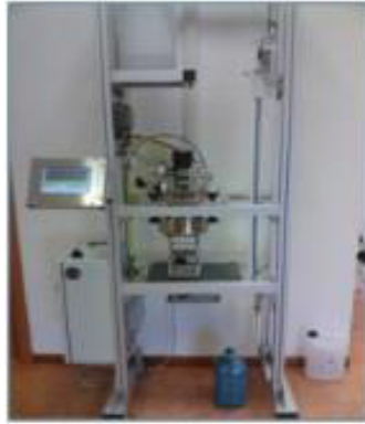
Fig. 1. Anaerobic digestion mini-plant
