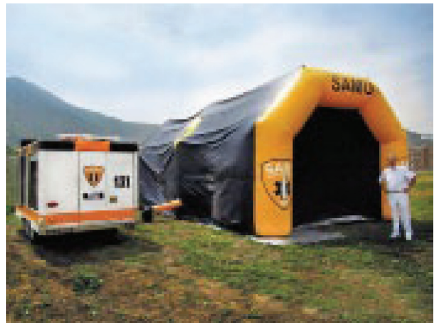
Figura 10. Carpa del PMA desplegada y unida a la turbina de alimentación de aire que está conectada al grupo electrógeno del carro. Se despliega en 6 a 8 minutos. Sus dimensiones: largo 8 metros, ancho interior 3 metros.
