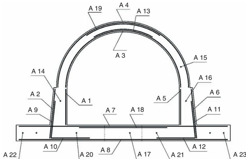
**Figura 2.** Armaduras consideradas en la optimización de la bóveda. Para mayor claridad no se ha esquematizado el anclaje de las armaduras –solo sus longitudes de cálculo–, ni las armaduras de cortante.
