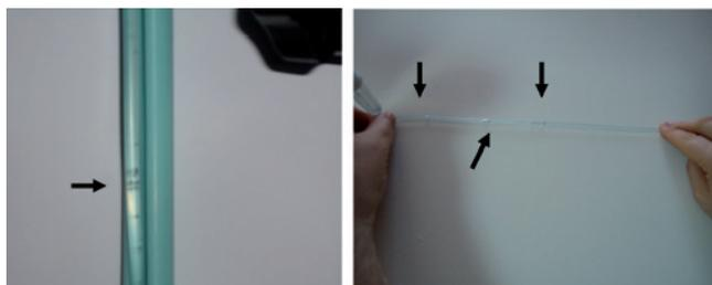
**Figura 3** Bolhas formadas no dispositivo da marca *S-line*.
