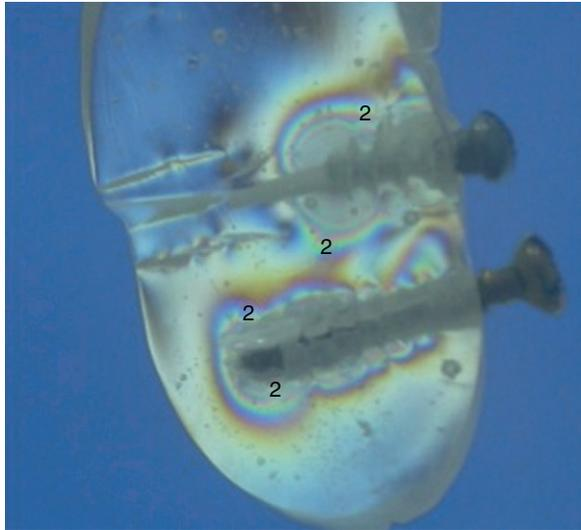
**Figura 4 – Espectro de tensiones alrededor de dos tornillos de 2 mm del sistema convencional. Nótese la gran concentración de tensiones alrededor de toda la longitud de los tornillos así como en la cortical externa del hueso mandibular, y en el espacio entre los tornillos.**
