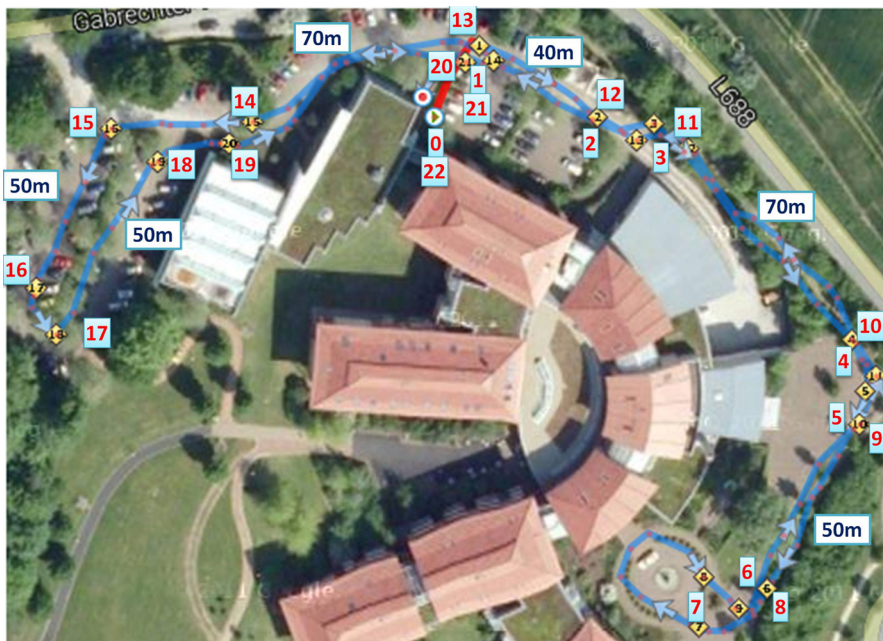
Abbildung 2 Messstrecke, Klinik Lindenplatz, Bad Sassendorf: Teil 1: Gewöhnung (Pkt. 1–13) mit Ebene (1–2; 5–6; 8–9), Steigung 2% (3–4) und Gefälle 2% (10–11). Teil 2: Hauptmessstrecke (13–20) mit Ebene (15–16; 17–18), Steigung 5% (19–20) und Gefälle 5% (13–14).
