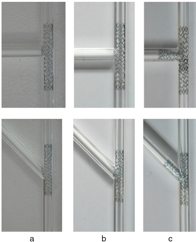
Figura 1. Técnicas de implante de stent en la bifurcación coronaria contempladas en este estudio. a) Stent simple en la rama principal. b) Stent simple en la rama principal con «kissing» a través de la rama lateral. c) Técnica «culotte».
