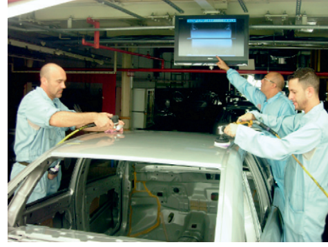
Figura 6: Monitorización de los defectos en la zona de reparación.
