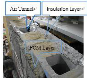
Fig. 5. actual structure of PCM wall
