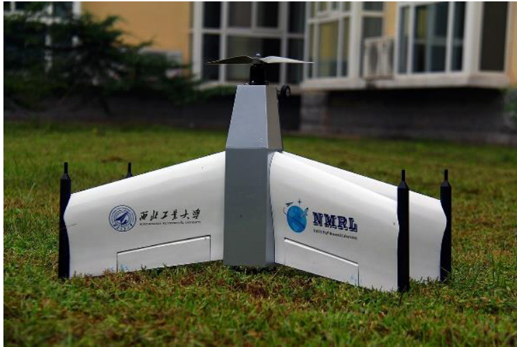
Fig. 1 Novlit-3 tail-sitter VTOL MAV
